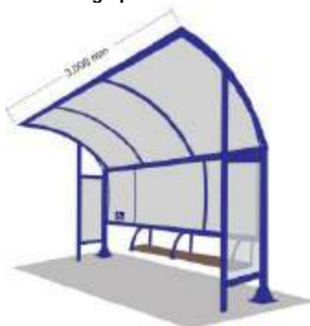
Figura 221 – Abrigo para Ponto de Parada Metálicos
